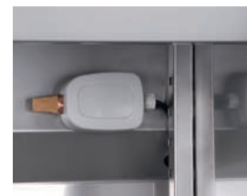
Sonda registro de humedad
